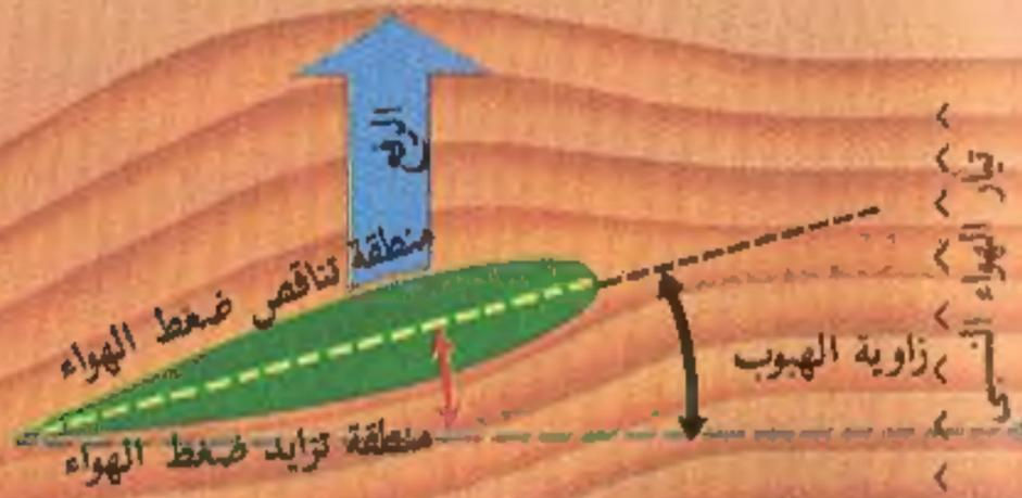
يظل تيار الهواء أنسيابياً حتى بلوغ زاوية الانهيار ، حيث يضطرب تيار الهواء فجأة ، فيحدث تناقص فجائي في الرفع وكل محاولة لزيادة إضافية في زاوية الهبوب تكون نتيجة تناقصاً إضافياً في قوة الرفع
